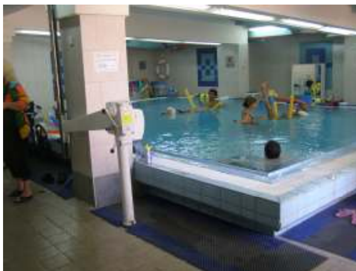
בריקה טיפולית ביי"ח אלי"ן ירושלים – דפנות בריכה מוגבהות עם מנוף הידראולי (נתקבל סיוע של הקרן להקמה והצטיידות)
