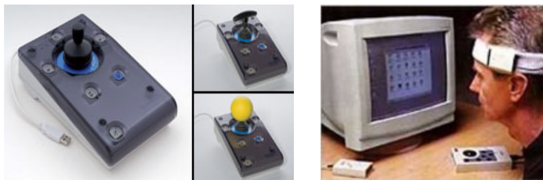
איור 1: דוגמאות לתחליפי עכבר
